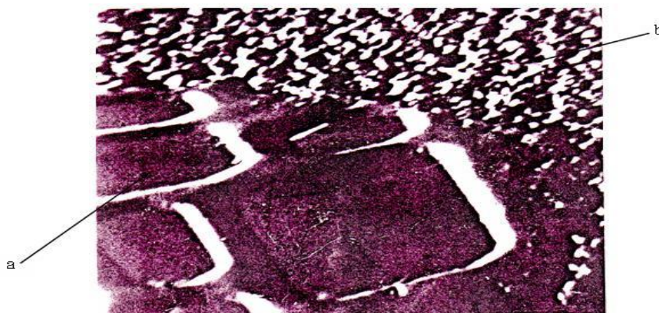
Рисунок 1. Электронно-микроскопические снимки пленок. а) поликристаллический Al б) аморфный металлический сплав Al_{0,8}Ni_{0,2}
